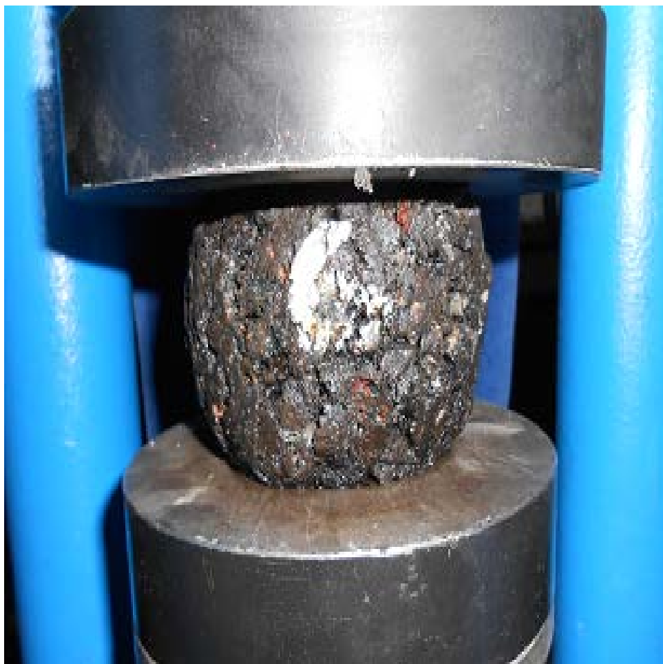
Рис. 5. Внешний вид образца из смеси на добавке Азол 8030 при приложении к нему начальной нагрузки прессы.
